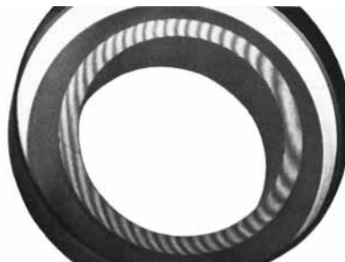
Nicht einwandfrei plane Gleitfläche
